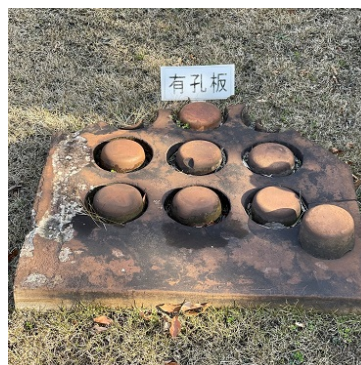
蒸留塔の有孔板 (穴のあいている板)
